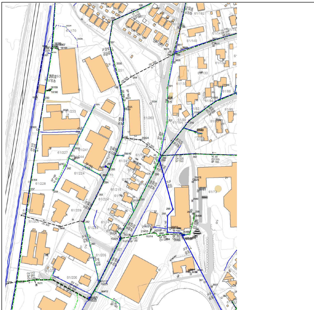
III.12 Plan som viser dagens ledningsnett. Nettet har god kapasitet og kan betjene Langbakken Nord fra et hovedstreck med vann og avløp som ligger langs jernbanelinjens østre side. Rørnettet for overvann har ikke tilstrekkelig kapasitet for å håndtere nedbørsmengdene som følger av klimaendringer. Det kommer overvannsledninger inn i planområdet fra høyreliggende områder øst for planområdet, og disse må inngå i fremtidige løsninger.
