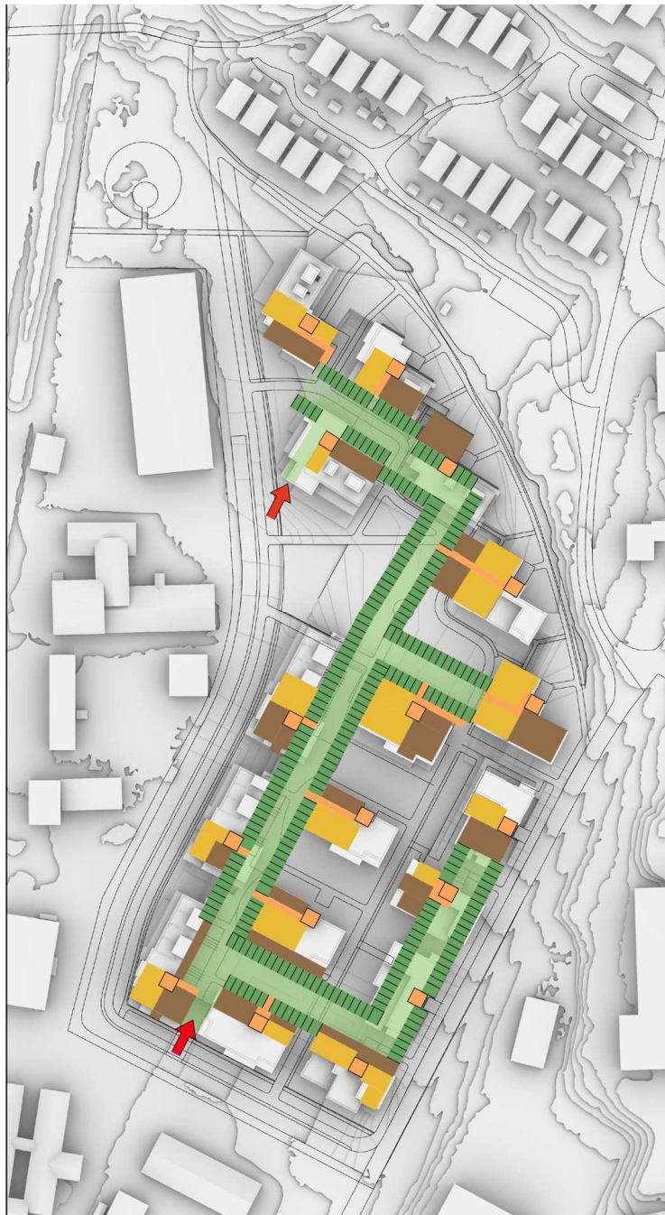
III. 49 Kjellerløsning med parkering av sykler og biler og med boder, alt knyttet nært til byggenes oppganger.
