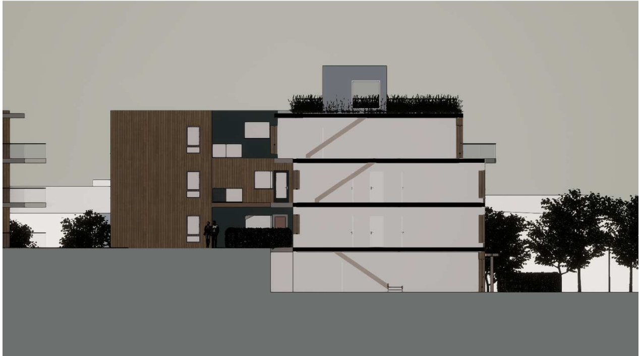
Ill.43 Bygg i felt B1. Snitt som viser takterrasse (for øverste to-plans leilighet) og utgang til terreng (for nederste to-plans leilighet).
