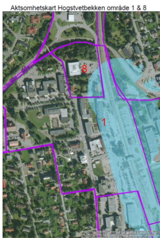
Fig.2. Potensiell 500-årsflom (lyseblå) i delområde 1 og 8 på grunn av oppstuvning i Hogstvetbekken.
