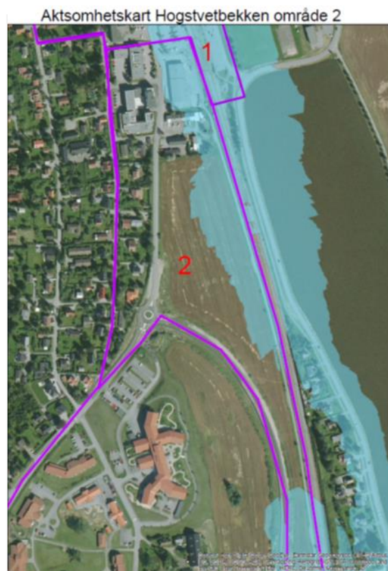
Fig.3. Potensiell 500-årsflom (lyseblå) i delområde 2 på grunn av oppstuvning i Hogstvetbekken.
