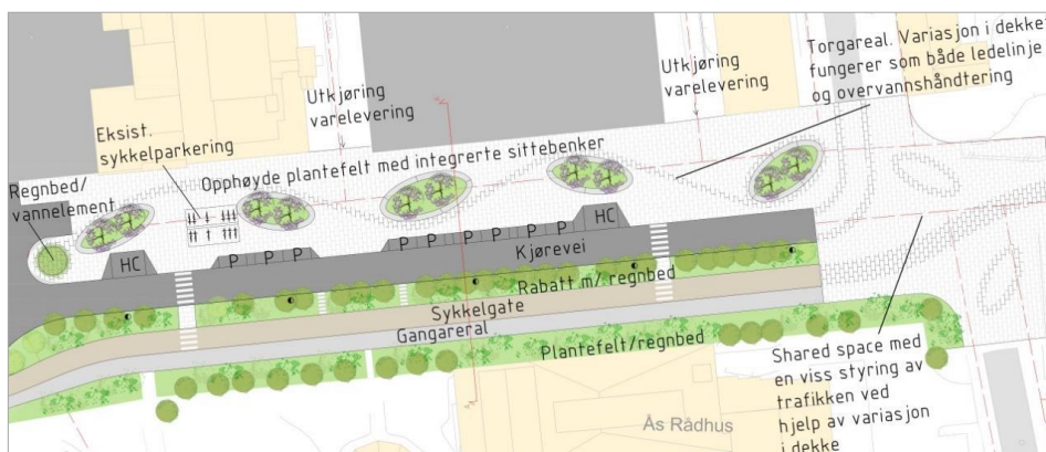
Figur 65. Statens vegvesens forslag til sykkeltrasé over Rådhusplassen. Forslaget innebærer at det stenges for gjennomkjøring mellom Moerveien (nede til høyre) og Rådhusplassen. (Kilde: Ås kommune)
