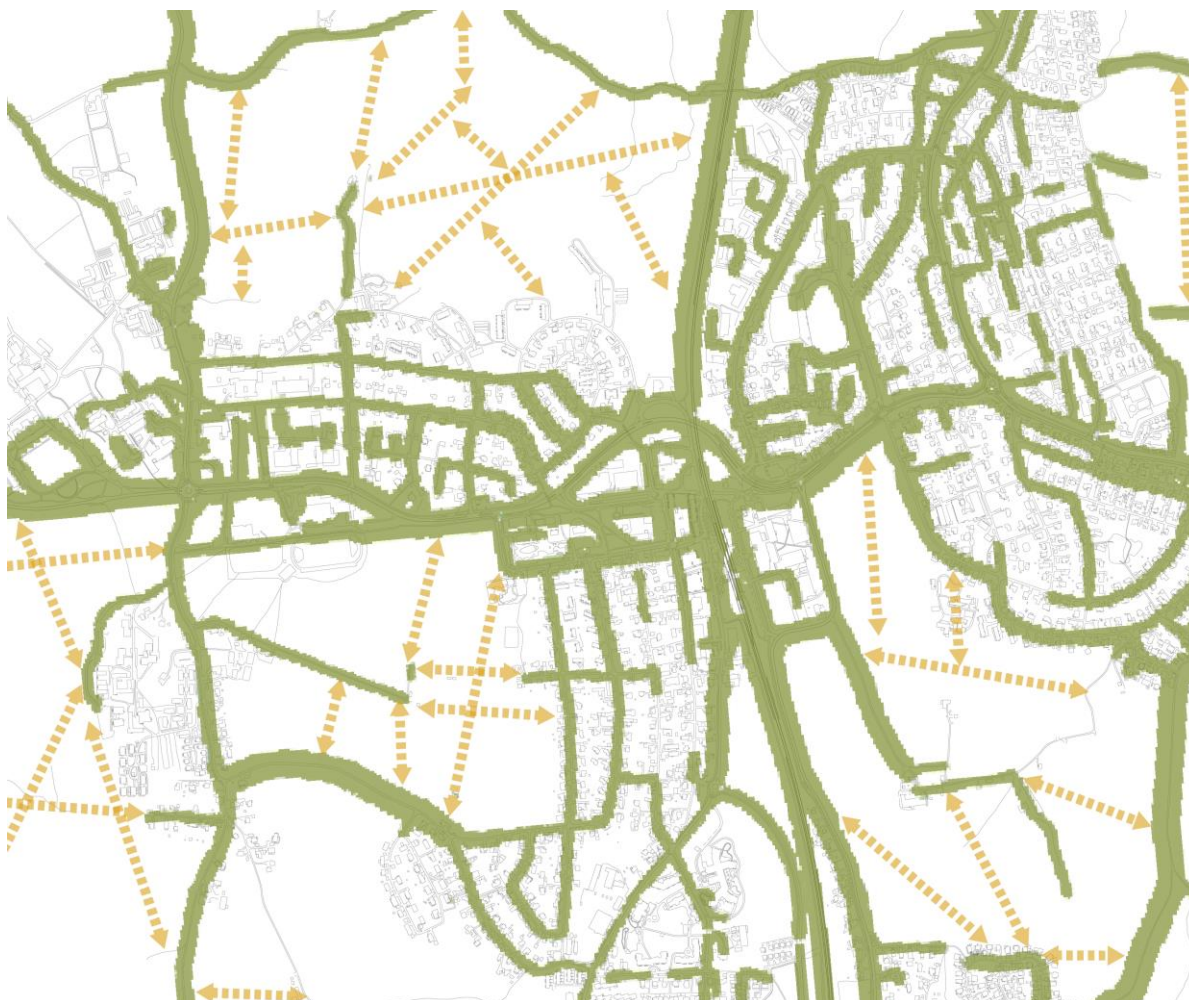
Figur 3.20 Kartet viser resultatene av pedaltrakk-undersøkelsen. De grønne strekene viser hvor folk sykler, eller ønsker å sykle. Jo tykkere streken er jo viktigere er traseen. De gule pilene viser hvor det er etterspurt nye koblinger for sykkel.
